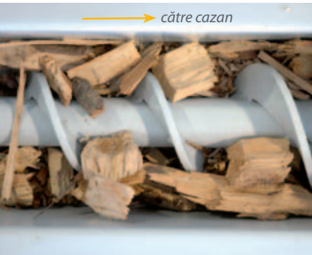
Forma elicoidală a melcului asigură furnizarea în cantități constant egale și fără probleme a combustibilului
