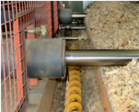
Antrenarea brațelor se realizează printr-un agregat și un cilindru hidraulic
