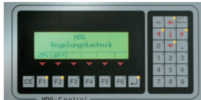
Panoul de operare complex a comenzii SPS afișază starea de funcționare actuală și permite afișarea în orice moment a datelor de funcționare.
